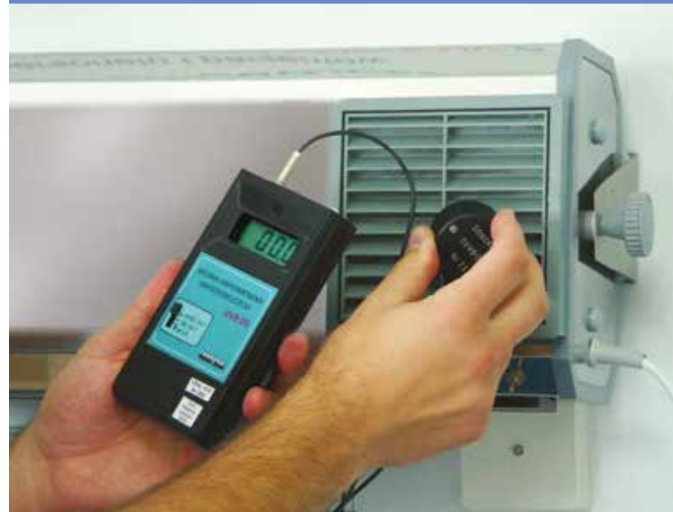
Bezpieczne dla ludzi – pomiar miernikiem napromieniowania wskazuje zero
