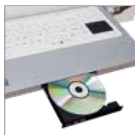
Zintegrowana stacja CD/DVD. Dostępna również w wersji do zabudowy (wysuwana z klawiatury)
