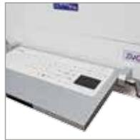
Clavier médical pliable, facile à désinfecter, avec le touchpad intégré et le revêtement antimicrobien. Versions avec clavier protégé par le film, en silicone ou en verre.
